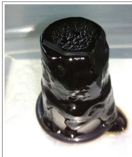
Figura 23 – Plug de óleo gelificado - ESP-04 - T_i = 50\text{ °C}
