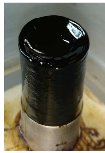
Figura 25 – Plug de óleo gelificado - ESP-04 - T_i = 60\text{ °C}
