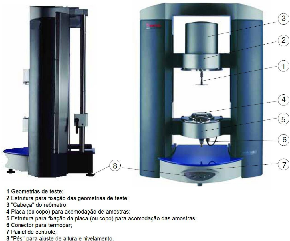
Figura 7 – Reômetro comercial modelo HAAKE MARS II.
