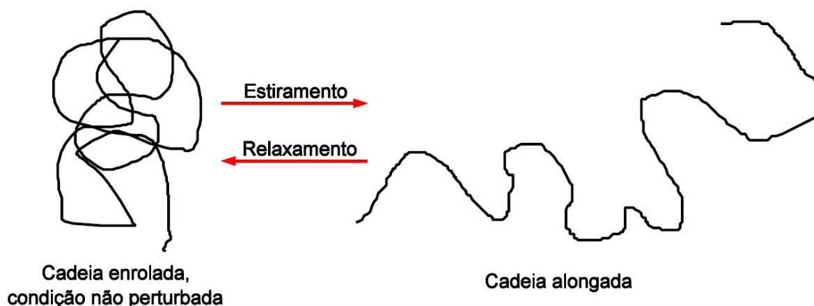
Figura 4 – Esquema do alongamento e relaxamento da cadeia polimérica. Adaptado de Kulicke e Clasen (2004).
