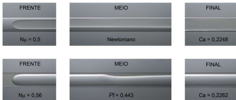
Figura 4.14: Comparação entre a estrutura da gota no caso newtoniano e no caso viscoplástico para N_{\mu} = 0,5 .
