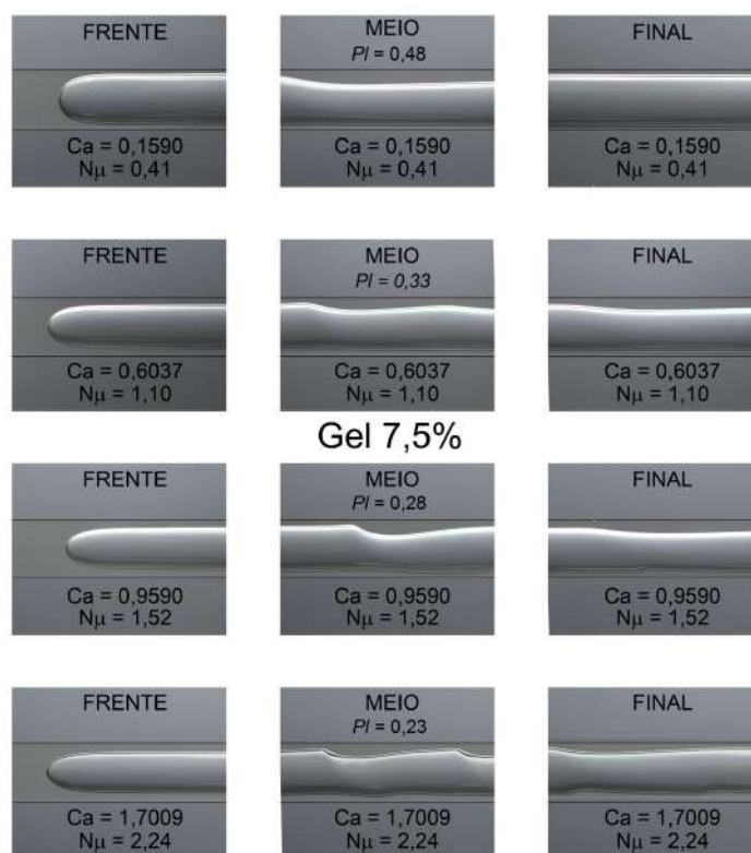
Figura 4.11: Estrutura da gota em diversos Ca e N_{\mu} no caso viscoplástico.
