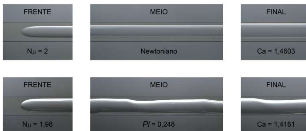
Figura 4.12: Comparação entre a estrutura da gota no caso newtoniano e no caso viscoplástico para N_\mu = 2 .
