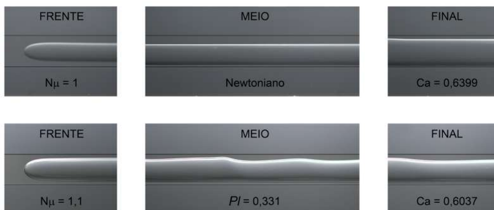
Figura 4.13: Comparação entre a estrutura da gota no caso newtoniano e no caso viscoplástico para N_{\mu} = 1 .
