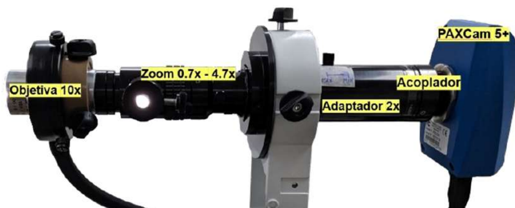
Figura 2.5: Microscópio óptico utilizado para micrografias das emulsões.
