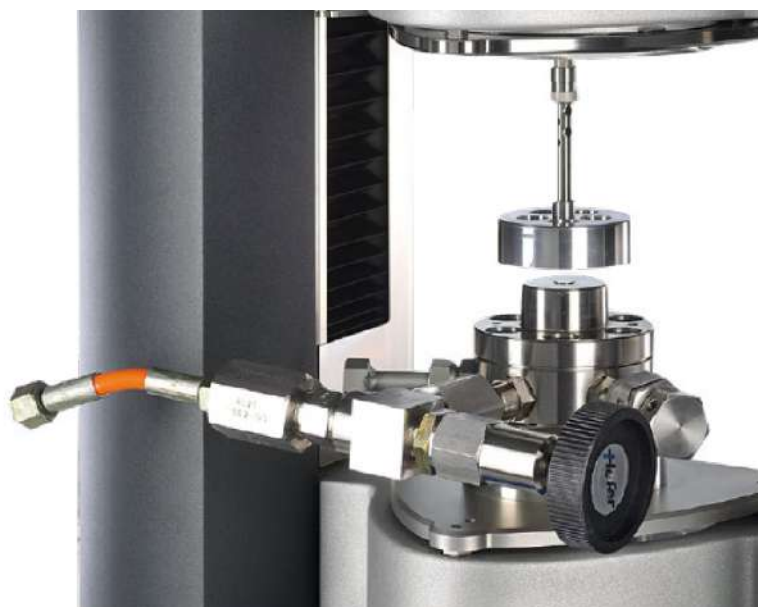
Figura 2.1: Célula de pressão conectada ao reômetro durante um teste.
