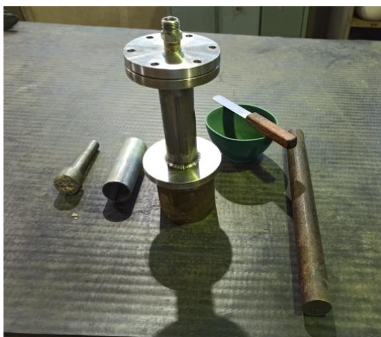
Figura 2.7: Representação da estrutura do meio poroso e itens utilizados para compactação da areia.
