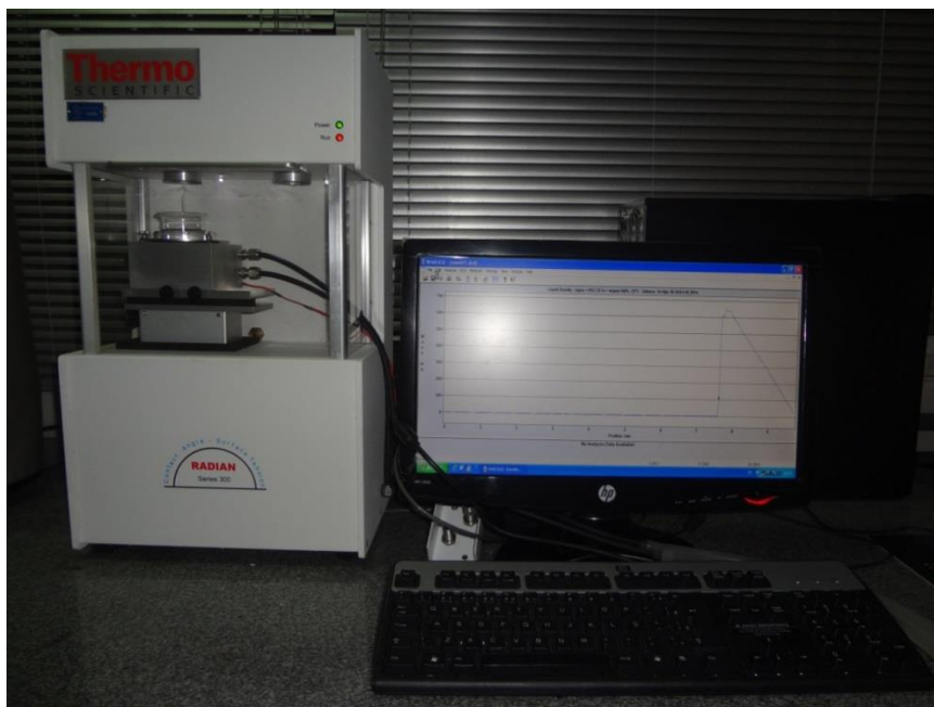
Figura 3.3 – Equipamento utilizado para medição das densidades dos fluidos.
