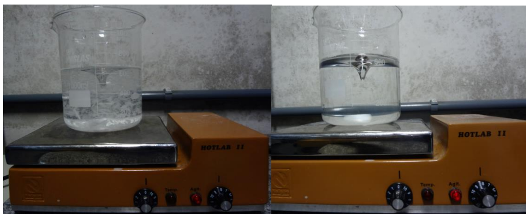
Figura 3.1 - Preparo da solução de PEG 70% peso / peso, início e final da homogeneização da mistura.
