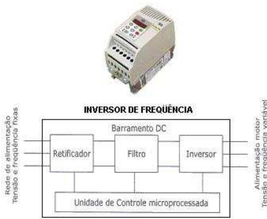
Figura 44 - Inversor de freqüência e seus componentes fundamentais
